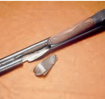
Laufsprengung als Folge einer nicht funktionssicheren Waffe
